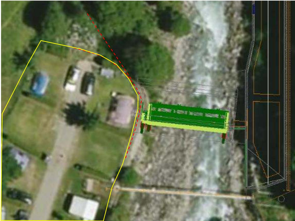
Vue en plan du barrage et de la digue le long du camping (pointillés rouges)
