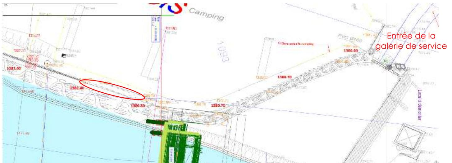
Comme illustré ci-dessus, la digue actuelle présente un décroché de 1.6 m (1382.40 -1380.80) en amont immédiat du barrage projeté et donc du dernier emplacement du camping. La digue à l'aval de ce décroché reste relativement au même niveau. La cote la plus basse est à 1380.60, au point le plus en aval de la digue.
