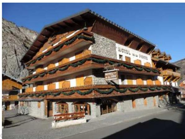
Plusieurs éléments composent les façades : la pierre en sous bassement et sur une partie de façade traité de manière verticale ; l'enduit et le bardage bois en sous pente et niveau comble.
