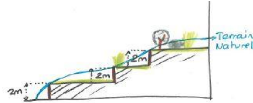
Principe de traitement des mouvements de terrain après travaux des espaces non bâtis.
