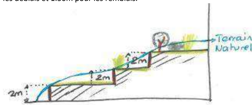
Principe de traitement des mouvements de terrain après travaux des espaces non bâtis.
